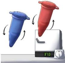
2. Entnehmen Sie ein Set aus CatFlux Kontroll- (blaues Gefäß) und Testlösung (rotes Gefäß) und überprüfen Sie, dass das angegebene Verfallsdatum nicht überschritten ist und die Lösungen in den Mikroreaktionsgefäßen mit bloßem Auge klar (frei von Schwebstoffen und Anzeichen für mikrobiellen Bewuchs) erscheinen. Kontaktieren Sie bitte den Hersteller, falls Sie Anzeichen für jegliche Arten von Verunreinigungen finden.
